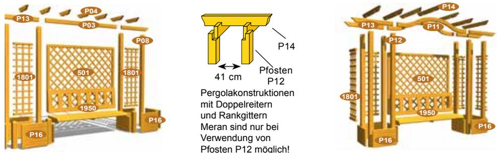
Pergolakonstruktionen mit Doppelreitern und Rankgittern Meran sind nur bei Verwendung von Pfosten P12 möglich!
