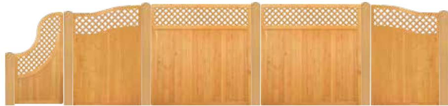
Elegantes Sichtschutzzaunprogramm aus Lärchenholz in edler Verarbeitung. Verzapfte Rahmen aus 45 x 70 mm Kantholz, Nut- und Federbretter 22 x 100 mm, mit Softlinekanten. Der obere Rahmen ist zusätzlich abgerundet und deckt die aufrechten Rahmenteile ab. Ebenso sind alle scharfen Kanten mit einer leichten Rundung versehen, um einen besseren Wasserablauf zu gewährleisten.
