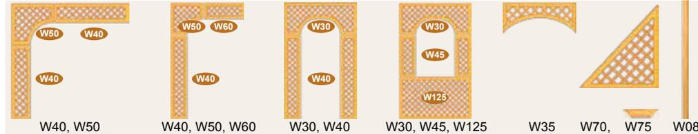
Werden die Gestaltungselemente für Pavillon W10 verwendet, so muss für die entsprechende Seite ein zusätzlicher Pfosten W08 eingeplant werden.
