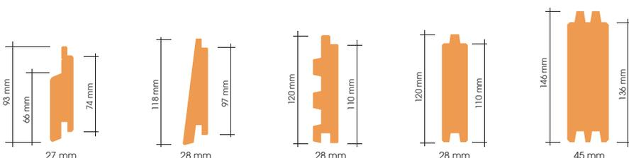
Alle Wandschalungen in nordischer Fichte und sibirischer Lärche erhältlich. Die Konstruktionshölzer sowie Türen und Fenster, weiterhin in nordischer Fichte.
